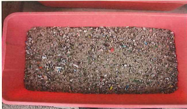
はんしゅつ 搬出ホッパ内部 ないぶ (不燃 ふねんざんさ 残渣)
