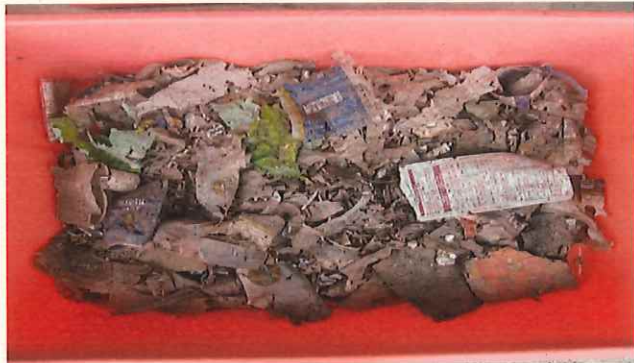
はんしゅつ 搬出ホッパ内部 ないぶ (可燃 かねんざんさ 残渣)
