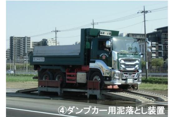
④ダンプカー用泥落とし装置
