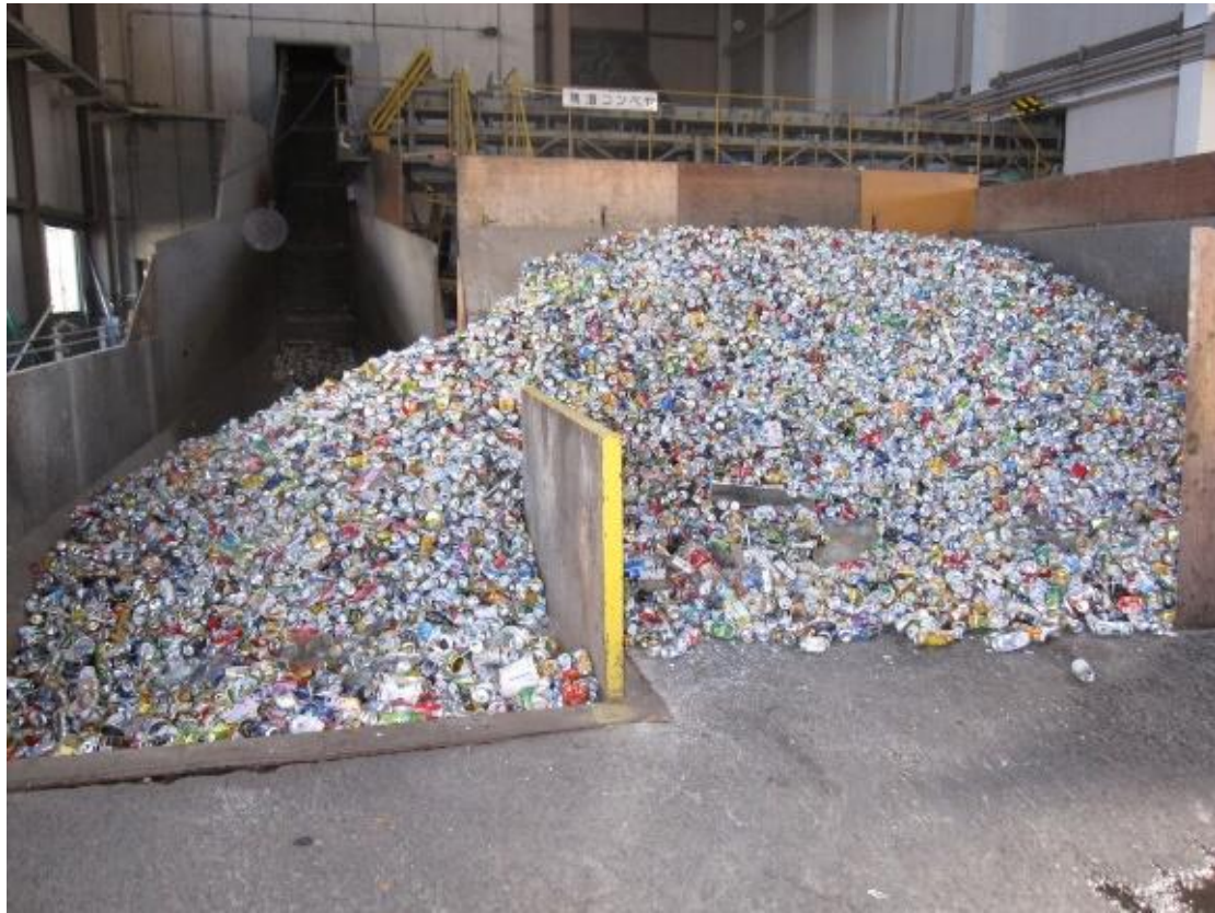
うけいれ とうにゅう しゃしんひだりおく) 受入ホッパと投入コンベア (写真左奥)
