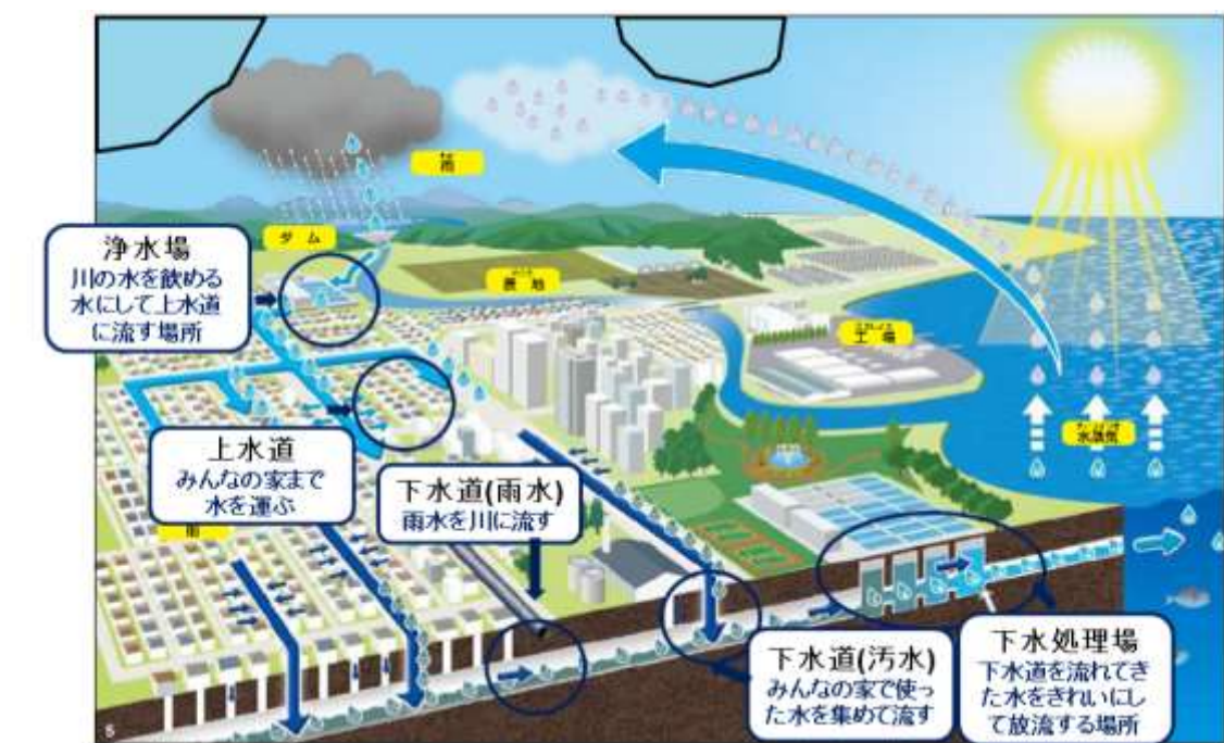
【下水道の仕組みと水の流れ】
