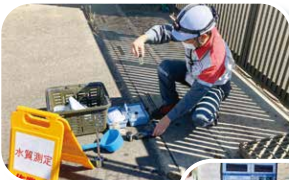
市内で残留塩素濃度を測定している様子
